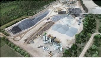
Der Betonaufbruch wird vor Ort mit einer mobilen Brecheranlage für den direkten Wiedereinbau aufbereitet.
