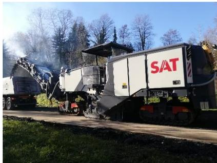
SAT Asphaltfräse im Einsatz
