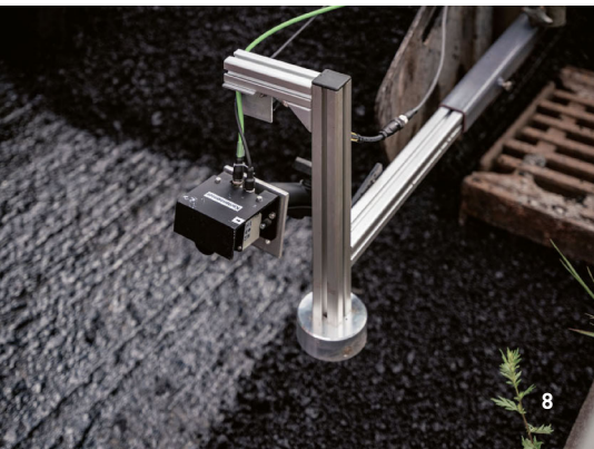
8 Kantensensor / 9 Controller auf dem Fertiger / 10 Messtechnik am Asphaltfertiger
